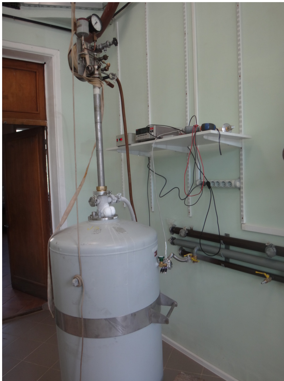
Рис. 1.2: Фото вставки в криостате с магнитом
