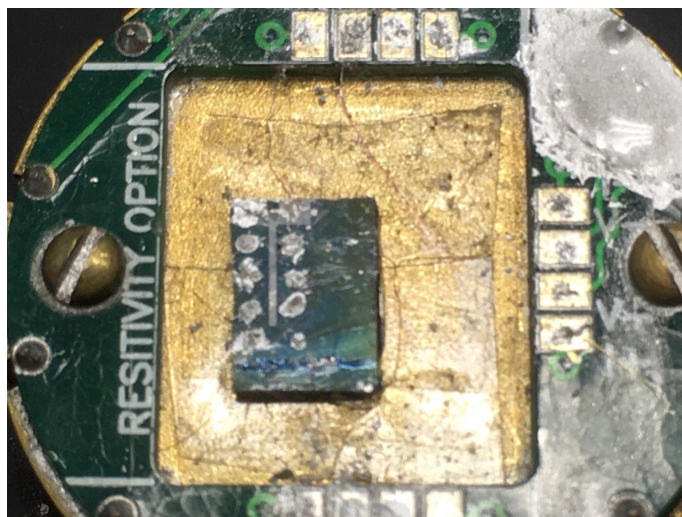
Рис. 12: Образец, смонтированный на вставке для работы с PPMS
