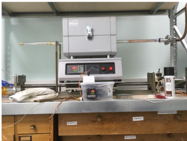
Рис. 21: Общий вид установки для напыления парилена.
