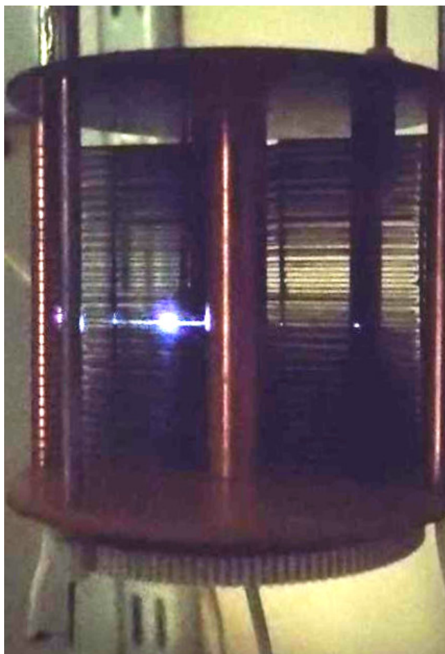
Рис. 6.3. Возникновение пробоя между пластинами конденсатора
