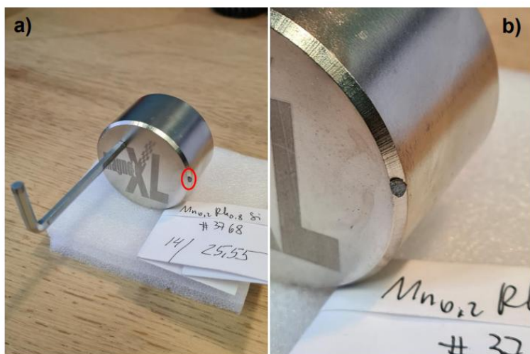
Рисунок 1. Образец Mn_{0.2}Rh_{0.8}Si удерживаемый к постоянным магнитом при комнатной температуре. а – Общий вид магнита с образцом (образец отмечен красным кружком). б – увеличенное изображение.
