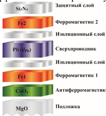
Рис. 1. Структура приготовленных образцов CoO x (3.5 нм)/Fe(3 нм)/[Si 3 N 4 /Pb/Si 3 N 4 ]/Fe(3 нм)/Si 3 N 4 (85 нм). Толщина слоя Pb ( d_{Pb} ) варьировалась от 40 до 60 нм, а толщины прилегающих слоев Si 3 N 4 ( d_{Si_3N_4} ) — от 0 до 1.2 нм.
