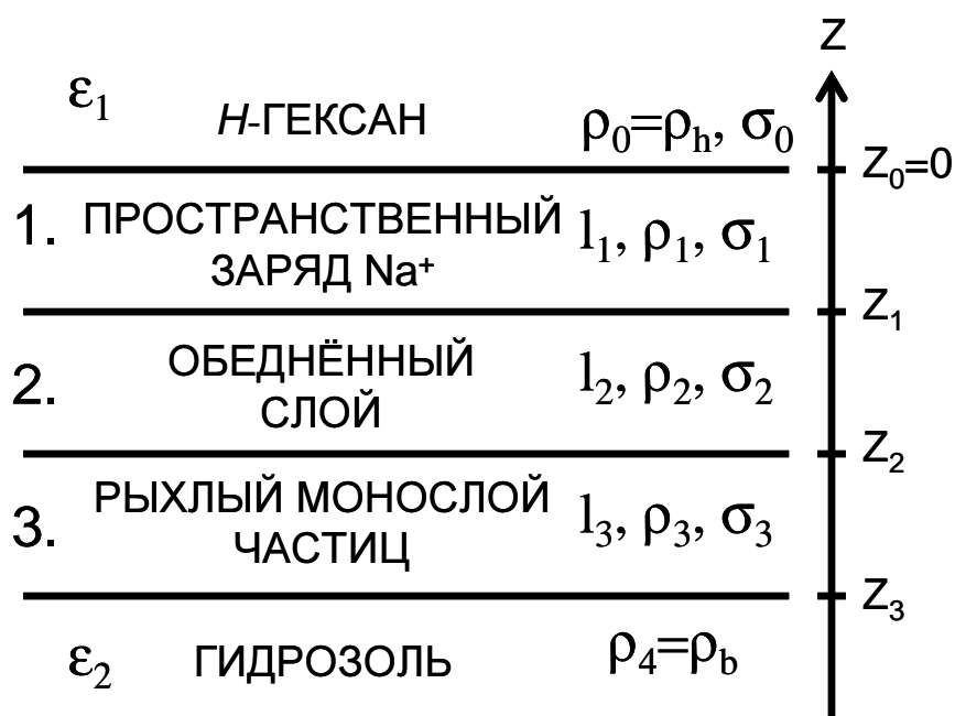
Рис. 8. Трёхслойная модель переходного слоя на границе н-гексан – кремнезёмный гидрозоль. Каждый слой имеет толщину l_j и электронную плотность \rho_j . Параметры \sigma_j задают ширину интерфейсов между слоями электронной плотности
